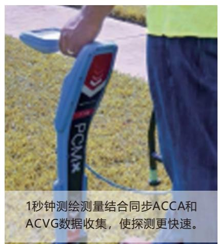
1秒钟测绘测量结合同步ACCA和ACVG数据收集，使探测更快速。
